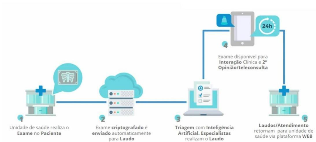
Figura 6 – Arquitetura para sistema de telemedicina (iSalut, 2020).
